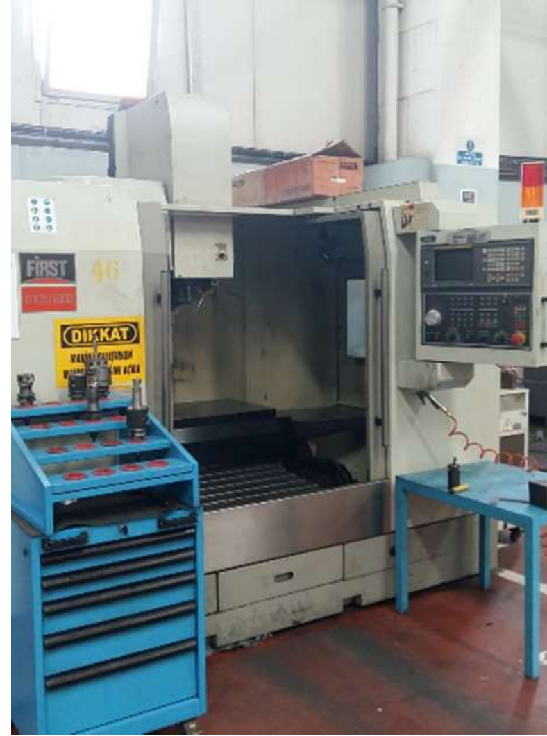
FIRST MCV 1000 3 Achsen CNC Maschine (x:1000/y:500/z:500)
