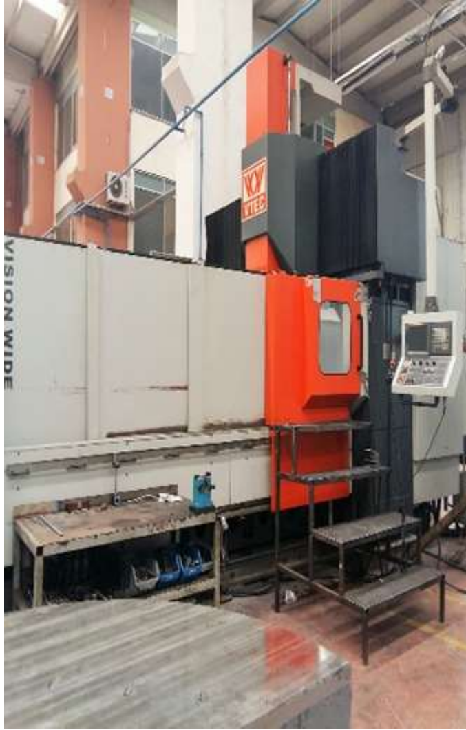
VTEC 3-Achsen-Brücken-CNC-Maschine (x:2450/y:3450/z:900)
