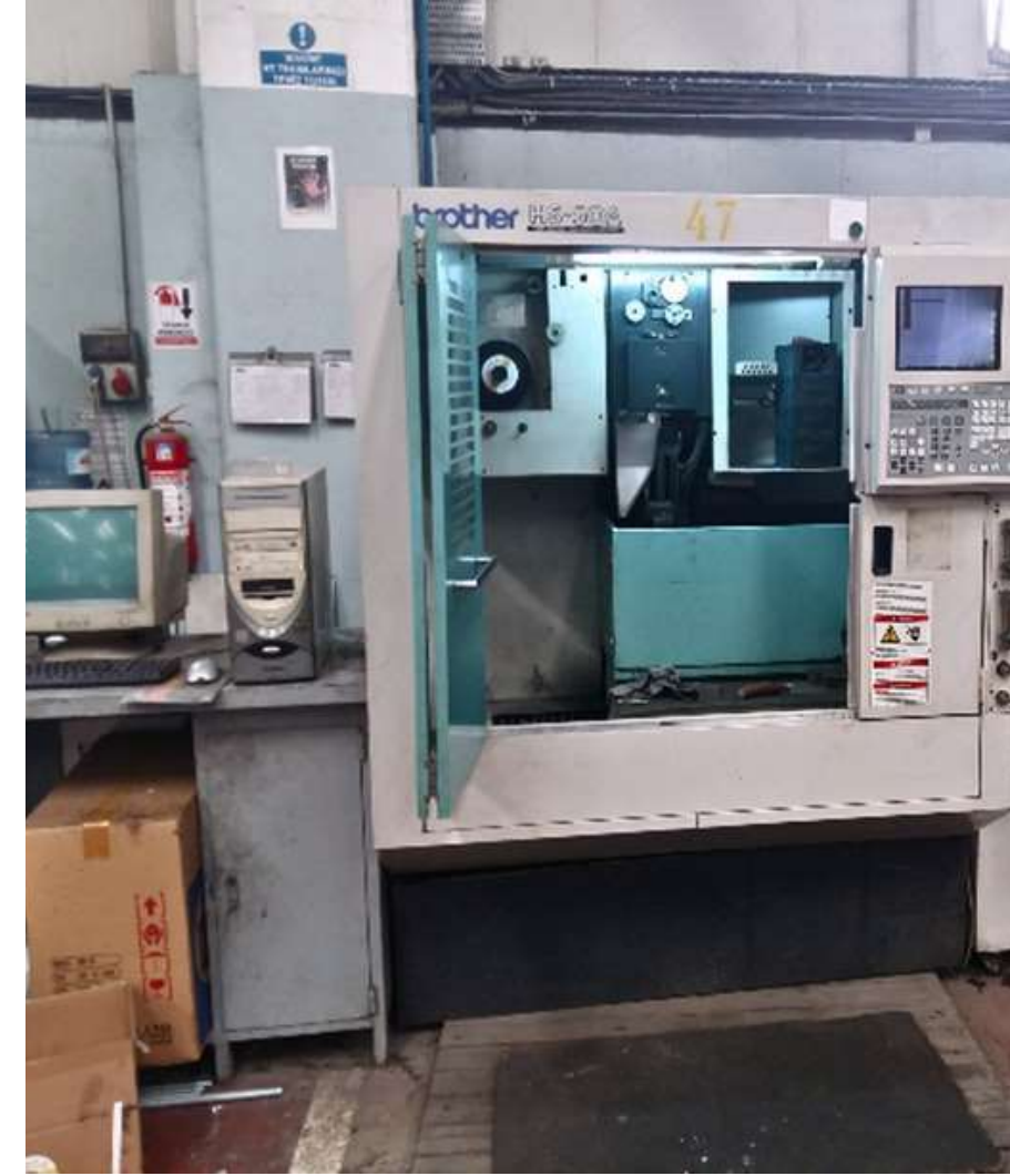
BROTHER HS-50A 4-Achsen- Drahterodiermaschine (x:420/y:260/z:160)
