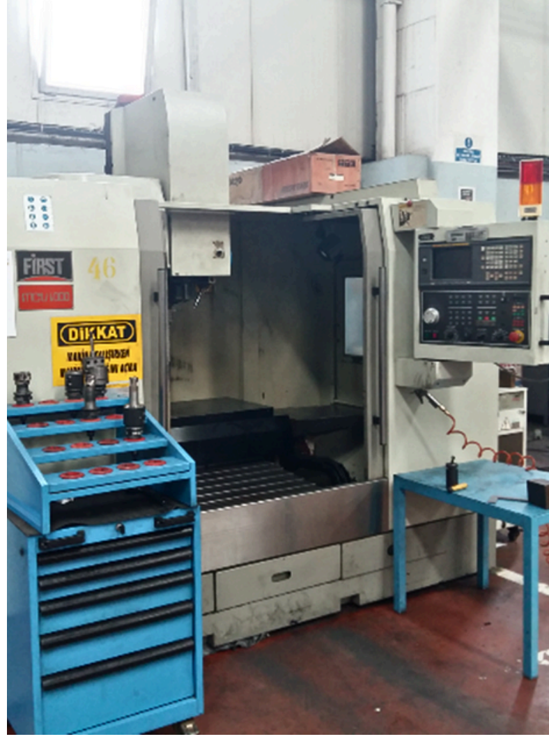
FIRST MCV 1000 3 Eksen CNC Tezgahı (x:1000/y:500/z:500)
