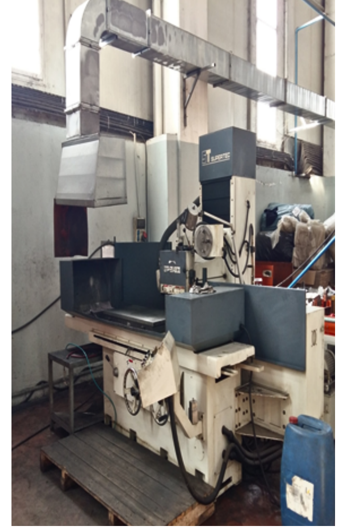
SUPERTEC Satır Taşlama (x:1000/y:500/z:500)
