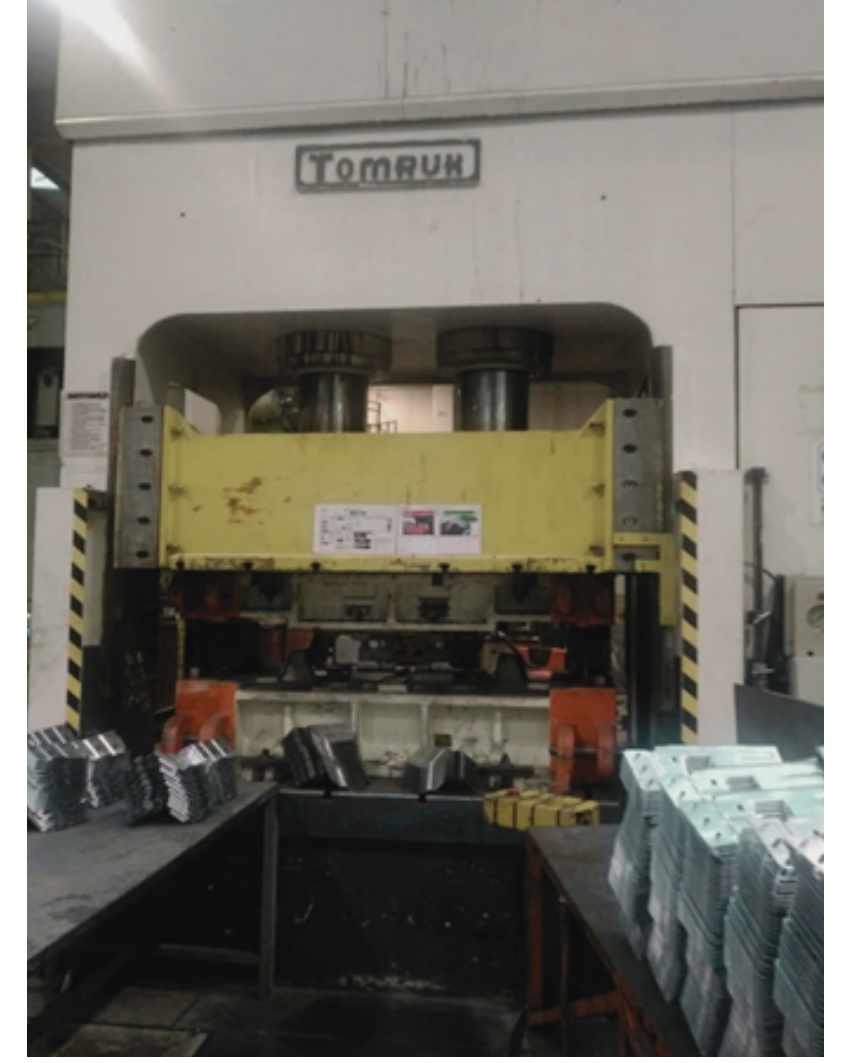
HİDROLİK PRES-LOGGING 350 TON (1700 X 1570 1700 X 1520)
