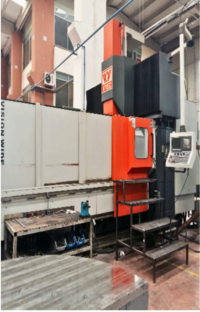
VTEC 3 Eksen Köprü Tipi CNC Tezgahı (x:2450/y:3450/z:900)
