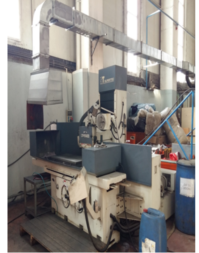
SUPERTEC Line Grinder (x:1000/y:500/z:500)
