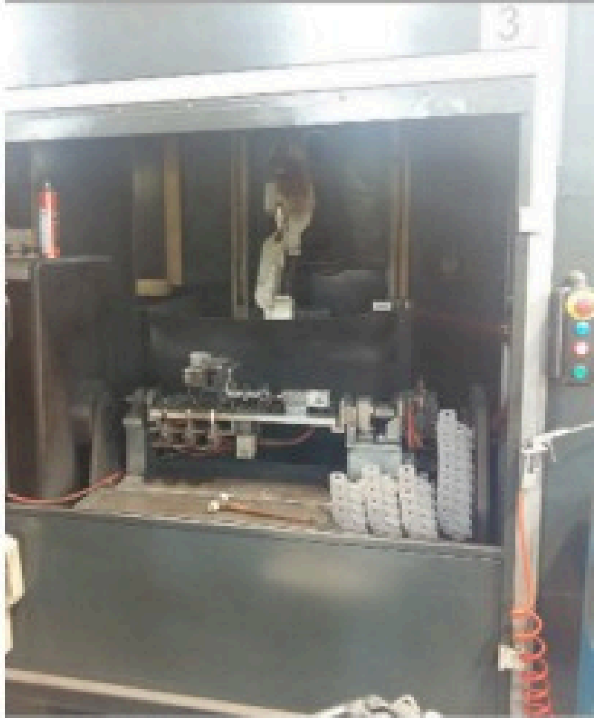
GAS UNDERGAS SCHWEISSEN ROBOTO 350 A DAIHEN (1 Stück)
