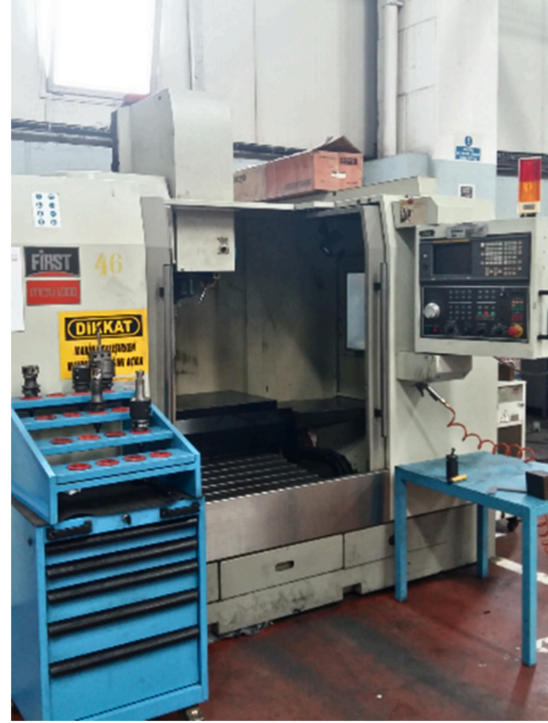
FIRST MCV 1000 3 Eksen CNC Tezgahı (x:1000/y:500/z:500)
