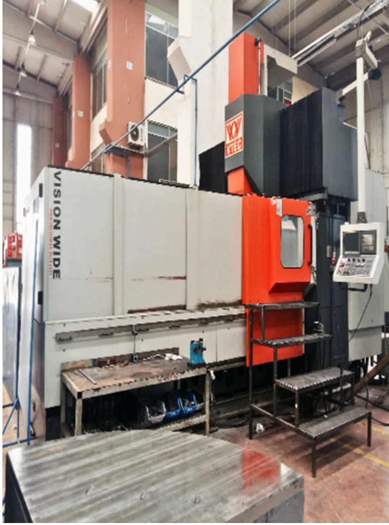
VTEC 3 Eksen Köprü Tipi CNC Tezgahı (x:2450/y:3450/z:900)
